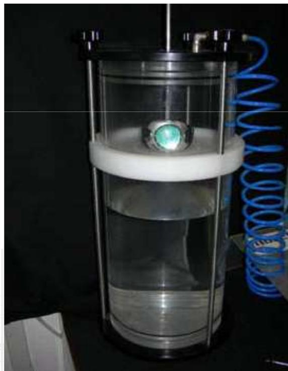
**Con el mecanismo de control, dar un valor de presión dentro de la cámara de unos 4 bar durante al menos cinco minutos.**
