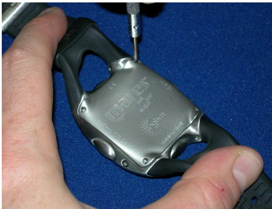
Desenroscar completamente los cuatro tornillos de la cubierta con el destornillador; extraerlos utilizando unas pinzas y ponerlos en un lugar limpio.
