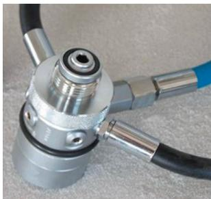
Está conectado a al grifería de la botella, que de acuerdo con la normativa de referencia en vigor, dispone de una conexión Nitrox DIN 26x2, (si es necesario, a petición, también está disponible 25x2 DIN o acoplamiento roscado de 26x2 a 25x2), reduce la presión de la botella de 200/300 bares a 13 bares (+ / - 2%), dispone de tres salidas a media presión de conexión 3/8 y dos salidas a alta presión conexión marcada como HP.
