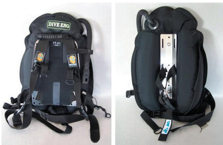
El chaleco que se suministra, es el tipo de estructura en mono saco de tejido trevira 420/840 dn., soldado mediante radio frecuencia, la capacidad de sustentación es de aproximadamente 18/19 kg. y el respaldo y su relativa placa esta fabricada en termo polímero reforzado, en el caso de respaldo y la placa de acero inoxidable (opcional), la sustentación se reduce a unos 16/17 kg. Está equipado con todos los arneses y
