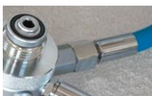
La presión intermedia de 13 bares constante proveniente del regulador de primera etapa pasa través del inyector de titanio (orificio sónico) que provoca un flujo constante de 9/9,5 litros por minuto (en el caso de la mezcla Nitrox 40 % para la máxima profundidad de 30 metros.) o de 14/14, 5 litros por minuto (en el caso de la mezcla Nitrox 32% para la máxima profundidad de 40 metros.).
